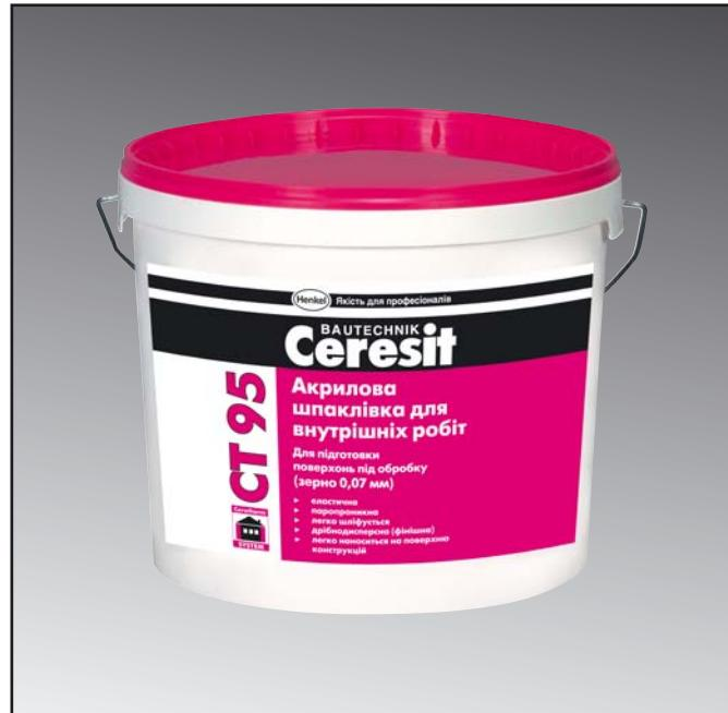
Шпаклевка наносится на поверхность до получения необходимой толщины несколькими слоями, толщина одного слоя не должна превышать 1,0–1,5 мм. Максимальная толщина шпаклевочного слоя не должна превышать 3 мм. В период высыхания шпаклевки ее нельзя сбрызгивать водой. Не высохший излишок материала на инструменте или подготовленной поверхности можно смыть водой. Затвердевшую шпаклевку можно удалить только механическим путем.
